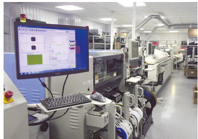
Линия поверхностного монтажа электронных компонентов
